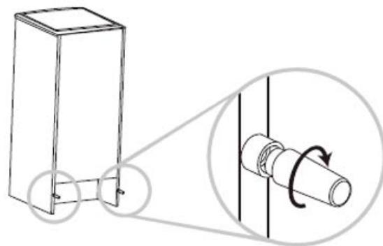
Das Gerät wird mit zwei Abstandshaltern aus Kunststoff geliefert (in der Plastiktüte der Bedienungsanleitung). Nach der Installation dieser Abstandhalter kann das Gerät nicht mehr gegen die Wand gedrückt werden, um eine ausreichende Belüftung zu gewährleisten. Setzen Sie die Abstandhalter in die entsprechenden Öffnungen auf der Rückseite des Geräts ein und schrauben Sie sie fest.
