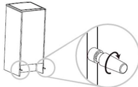
L'appareil est fourni avec deux embouts en plastique (dans le sac en plastique du manuel d'utilisation). Après l'installation de ces embouts, l'appareil ne peut plus être poussé contre le mur pour assurer une ventilation adéquate. Insérez les embouts dans les ouvertures correspondantes à l'arrière de l'appareil, puis vissez-les.
